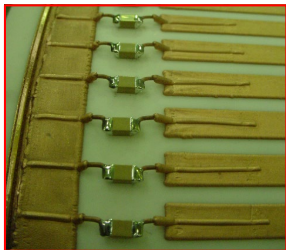
Capacitor Capacitance : 330nF
