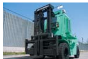
放射線を遮蔽するキャンピング搭載の大型特殊フォークリフト
