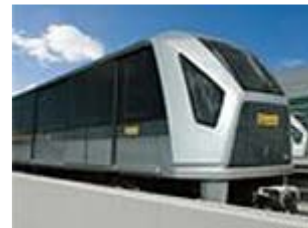
APM (Automated People Mover: ゴムタイヤ式新交通システム)
