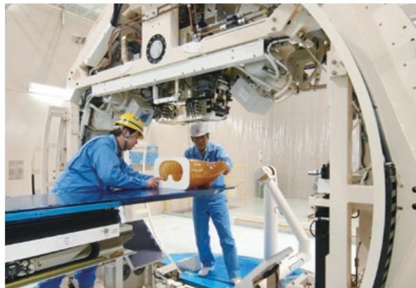
人体模型を使ってピンポイント照射の精度を入念にチェック
