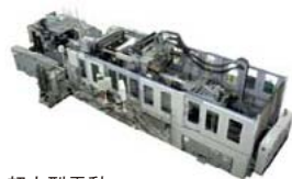
超大型電動 二材回転射出成形機「3000emR」
