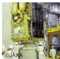
「いぶき」および小型副衛星と、衛星分離部との結合
