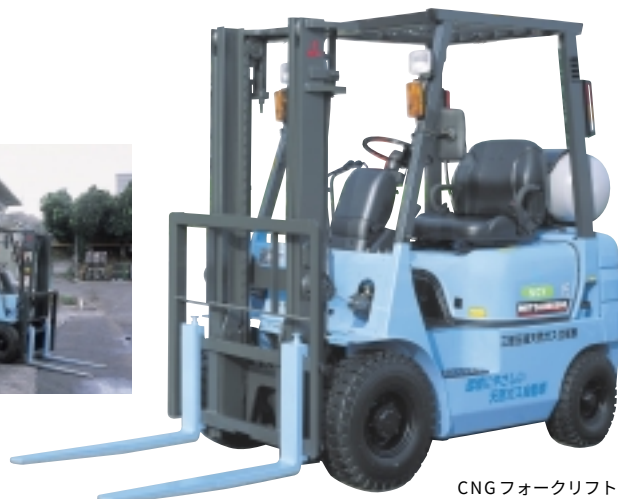
CNG フォークリフト
