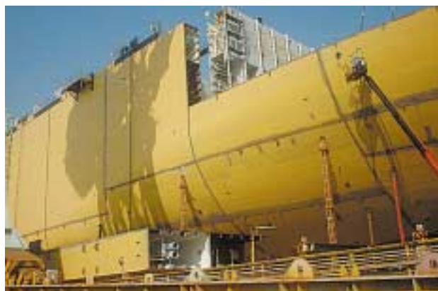
船の建造の過程で塗料が多く使用される
